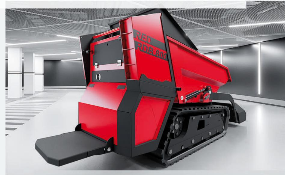
Отличается от самосвала меньшими габаритами, повышенной маневренностью, возможностью челночного хода (движение в обе стороны без разворота). Машины используются на стройплощадках и в стесненных условиях – внутри зданий, в тоннелях, горных выработках.
