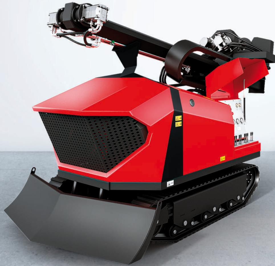
МАЛОГАБАРНТНАЯ БУРОВАЯ УСТАНОВКА ГУСЕНИЧНОГО ТИПА RED MARS 001, ПРЕДНАЗНАЧЕНА ДЛЯ БУРЕНИЯ ИНЖЕНЕРНЫХ СКВАЖИН В ПОРОДАХ I-XII КАТЕГОРИИ ПО БУРИМОСТИ, В ЧАСТОСТИ, ДЛЯ БУРЕНИЯ СКВАЖИН НА ВОДУ, СКВАЖИН ПОД ГЕОТЕРМАЛЬНОЕ ОТОПЛЕНИЕ, ИНЖЕНЕРНО-ГЕОЛОГИЧЕСКИЕ ИЗЫСКАНИЯ, СВАИ РАЗЛИЧНОГО НАЗНАЧЕНИЯ, И ДРУГИХ РАБОТ В СТЕСНЕННЫХ УСЛОВИЯХ.
