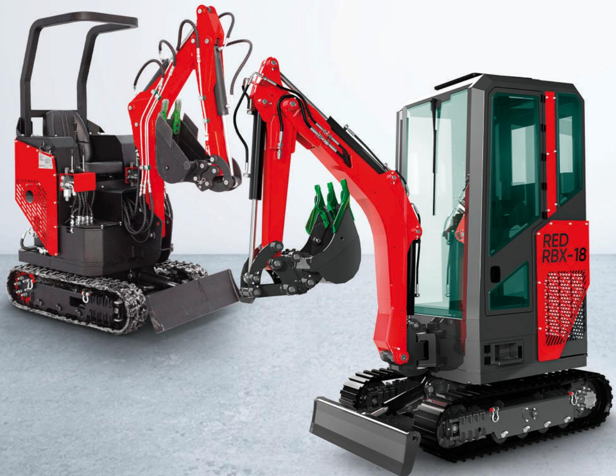
ЭКСКАВАТОРЫ СЕРИИ RBX ИМЕЮТ ПОЛНОПОВОРОТНУЮ КАБИНУ, ЧТО ЗНАЧИТЕЛЬНО РАСШИРЯЕТ ФУНКЦИОНАЛ ТЕХНИКИ, И ПОЗВОЛЯЕТ ИСПОЛЬЗОВАТЬ ЕЁ В СПЕЦИФИЧЕСКИХ УСЛОВИЯХ, ГДЕ НЕ СМОЖЕТ РАБОТАТЬ ЛЮБАЯ ДРУГАЯ ТЕХНИКА. В ДОПОЛНЕНИЕ К ПОЛНОПОВОРОТНОЙ КАБИНЕ, ТЕХНИКА ОБОРУДОВАНА ПОВОРОТНОЙ СТРЕЛОЙ, ЧТО ПОЗВОЛЯЕТ ВЫПОЛНЯТЬ РАБОТЫ В НЕПОСРЕДСТВЕННОЙ БЛИЗОСТИ ОТ ЗАБОРОВ, СТЕН И ДРУГИХ КРУПНЫХ ОБЪЕКТОВ.
